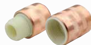
Maneguet antielectròlisi MT PN-16 1", 1/2", 3/4". Coure 99,9%, interior de poliamida 6.0 + 30% fibra de vidre. 872F1...
